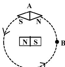
۹۴- یک آهنربای میله‌ای مطابق شکل رویرو، روی یک میز قرار دارد. یک عقریه مغناطیسی آزادانه می‌تواند حول محور قائم بچرخد. اگر عقریه روی مسیر نشان داده شده، از A تا B جابجا شود، در این مسیر، عقریه چند درجه دوران می‌کند؟
