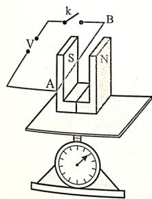
۹۳- دانش آموزی در طراحی یک آزمایش، آهنربای نعلی شکلی را روی کفه یک ترازوی حساس قرار داده، سپس سیم AB را مطابق شکل از میان دو قطب آهنربا عبور می‌دهد. اگر قبل از بستن کلید، ترازو عدد  $5N$  و پس از بستن کلید عدد  $\frac{4}{5}N$  را نشان دهد، جهت نیروی الکترومغناطیسی وارد بر سیم و جهت جریان در سیم به ترتیب از راست به چپ کدام است؟
